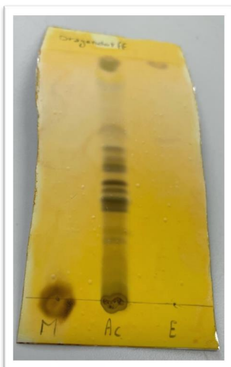
Figure 32. Chromatogramme après chauffage révélé par le réactif de Dragendorff en visible dans le système toluène/ \text{CHCl}_3 /MeOH : (20/70/10).
